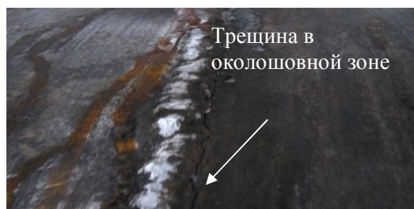
Рис. 1. Трещина в околошовной зоне сварного соединения после ремонта корпуса насоса
