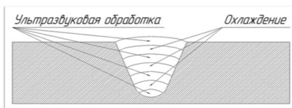
Рис. 5. Технология сварки с применением сопутствующего охлаждения и ультразвуковой обработки
