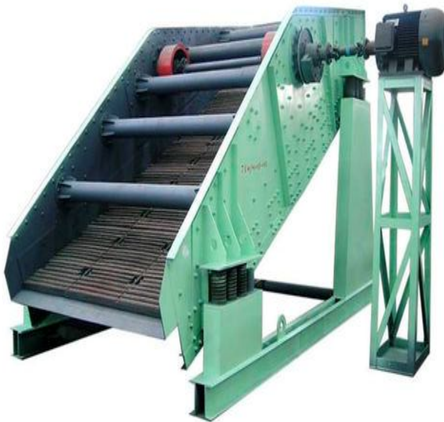
Рис. 1. Вибрационный грохот инерционного типа с карданной передачей в трансмиссии дебалансного вибровозбудителя
