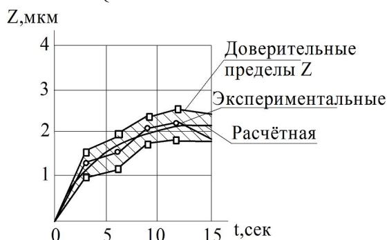
Рис. 4. Сравнительные данные экспериментальных и рассчитанных по формуле (6) значений удаляемого припуска Z мкм при обкатывании.
