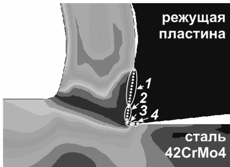
Рис. 2. Зоны контакта режущей пластины с обрабатываемым материалом
