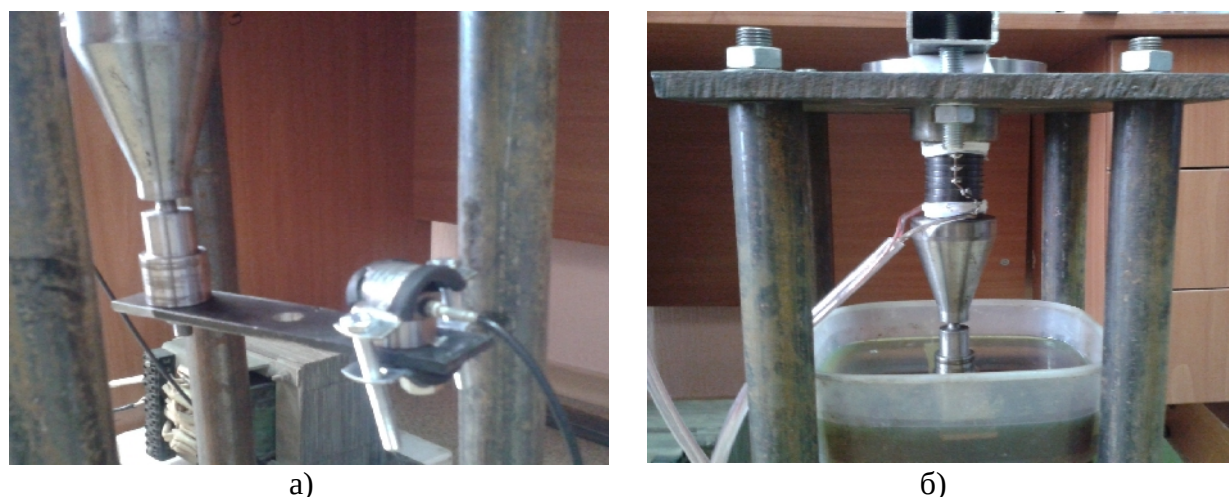
Рис. 1. Обробка алюмінієвої пластини на експериментальній установці для ЗВОПС (а – вимірювання резонансних частот; б – обробка в індустріальному маслі)
