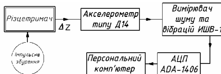
Рис. 4. Блок-схема стенду для дослідження вільних затухаючих коливань віджимної частини різцетримача
