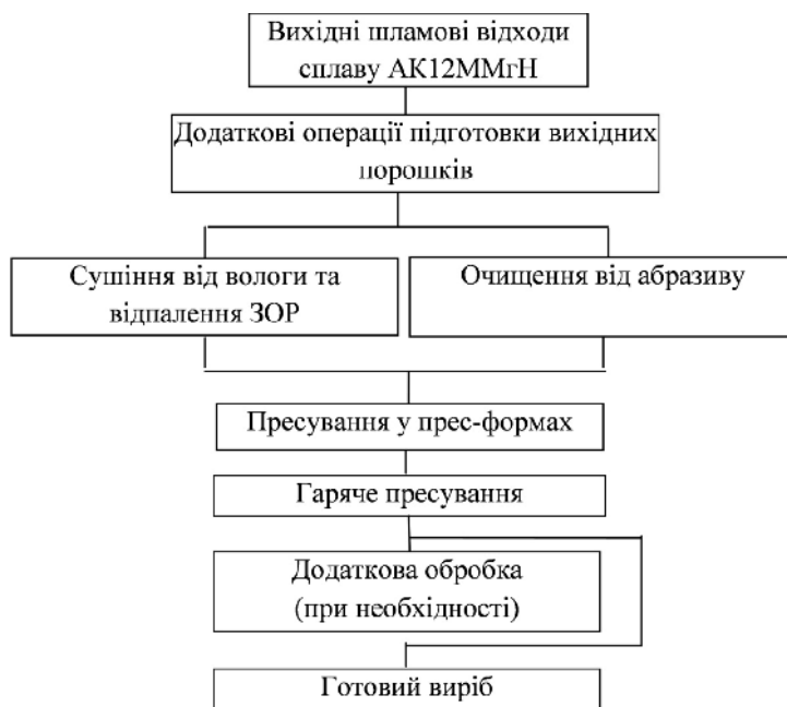
Рис. 1. Технологічна схема виготовлення антифрикційних матеріалів з відходів сплаву АК12ММгН [1]
