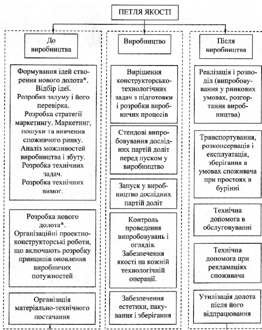
Рис. 1. Схематична модель петлі якості долота відповідно до міжнародних стандартів ISO 9000 (нове долото* – долото модернізоване чи нової конструкції, типорозміру, або виготовлене за новою технологією, з підвищеними вимогами по точності, якості тощо)
