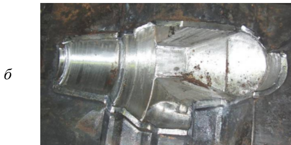
Рис. 2. Матриця (а) і пуансон (б) для штампування поковки лапи секційного тришарашкового бурового долота
