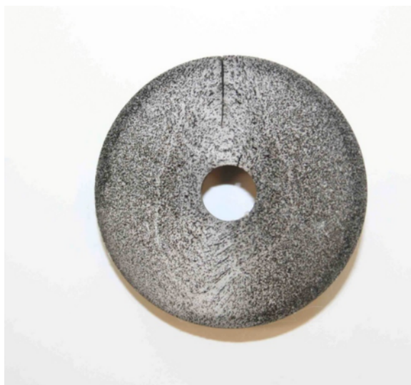
Рис. 2. Ликвационный квадрат в сечении макрошлифа детали
