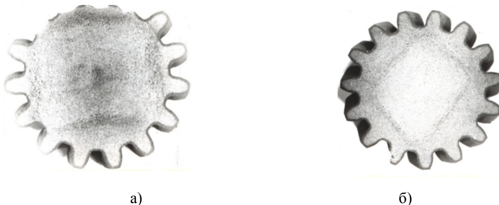
Рис. 1. Макроструктура сечения деталей с расположением ликвационного квадрата у основания зуба (а) и в центральной части (б) шестерни
