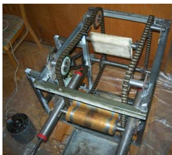
Рис.13. Экспериментальная установка валковой отжимной машины вертикального типа (ИМиСС АН РУз)
