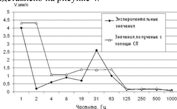
Рис. 4. Экспериментальные и теоретические значения виброскоростей, полученные в результате численного моделирования значения виброскоростей
