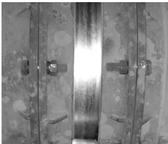
Рис. 3. Ослабление резьбовых соединений промежуточной вставки барабана
