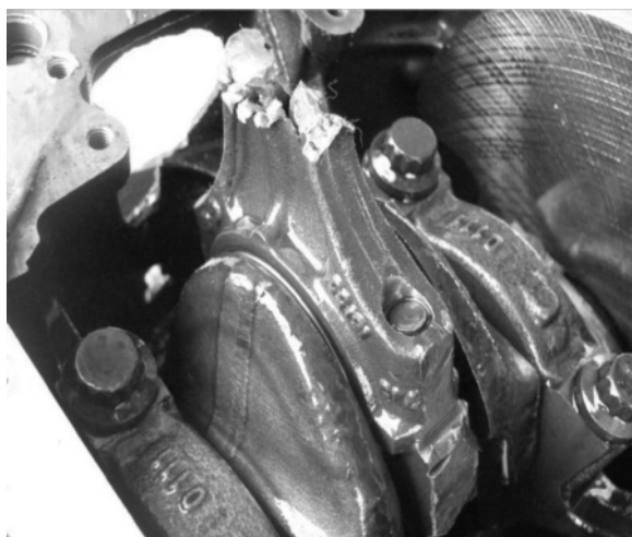
Рис. 2. Разрушение шатуна вследствие наличия производственного дефекта
