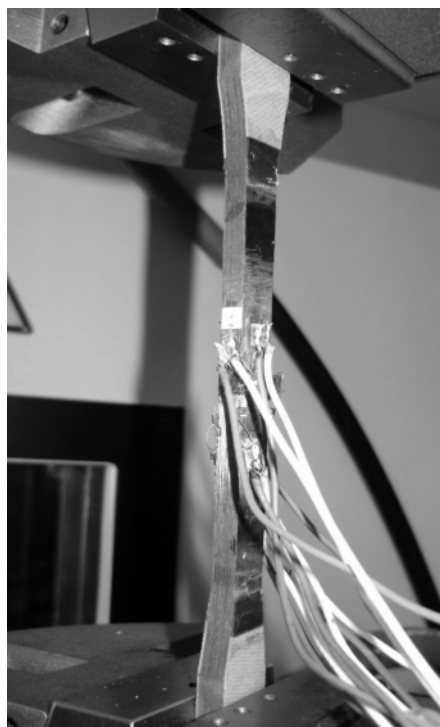
Рис. 1. Образец углепластика КМУ-3Л в захватах машины Instron
