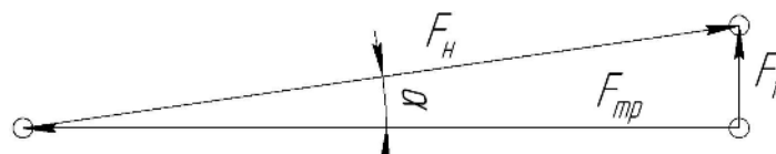
Рис. 2. Сили, що діють на канат
