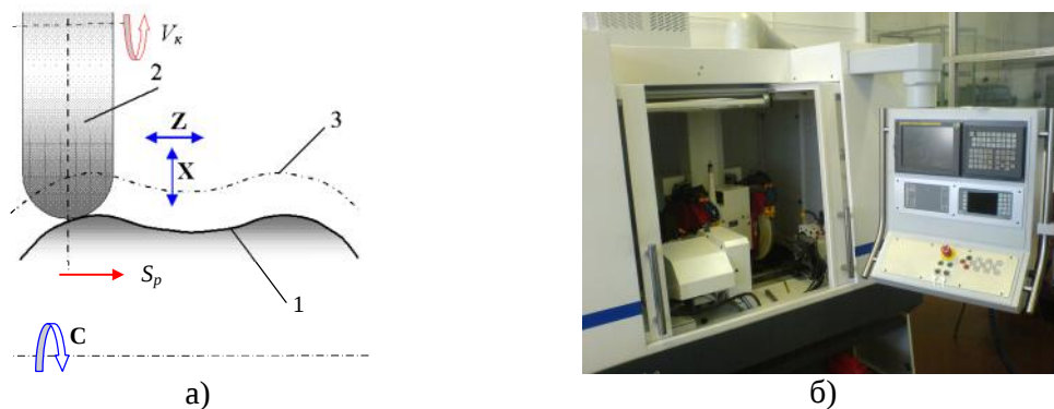
Рис.2. Схема формоутворення (а) і шліфувальний верстат з ЧПК Studer (б)
