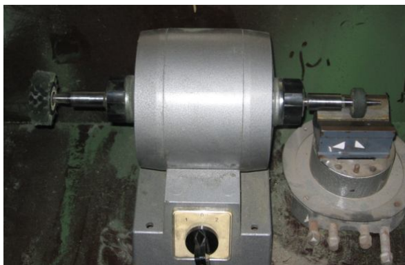
Рис. 3. Полировальный станок для специальной обработки изделий с покрытиями
