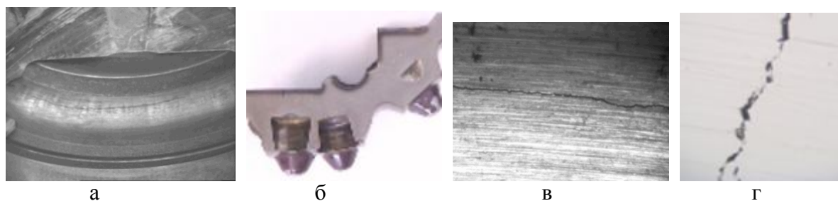
Рис. 2. Тріщина на кульковій біговій доріжці шарошки № 2 долота 250,8ТКЗ-ПГВ: а – загальний вигляд (макротемплет); б – травлений темплет для металографічних аналізів; в – вигляд поверхневої тріщини на темплеті в зоні бігової доріжки (? 2); г – тріщина в перерізі кулькової бігової доріжки на темплеті (? 100)
