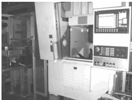
Рис. 4. Загальний вигляд токарного центру VSC-500 виробництва фірми „EMAG”, налагодженого для обробки порожнин шарошок бурових доліт
