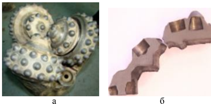
Рис. 1. Крихке руйнування шарошки долота 250,8 ТКЗ-ПГВ: а – загальний вигляд зруйнованого долота; б – темплет з розколеної шарошки
