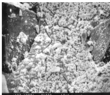
Рис.2. Микрорельеф поверхности алмазного инструмента, подвергнутого НТХО в оксидной Ti-Mo суспензии
