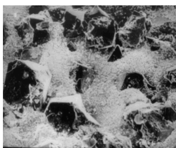
Рис.2. Микрорельеф поверхности алмазного инструмента, подвергнутого НТХО в оксидной Ti-Mo суспензии
