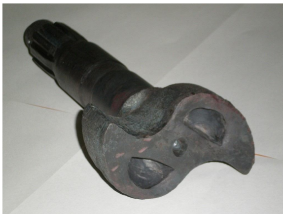
Рис. 7. Восстановленный разжимной кулак
