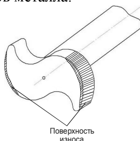
Рис. 4. Разжимной кулак после эксплуатации
