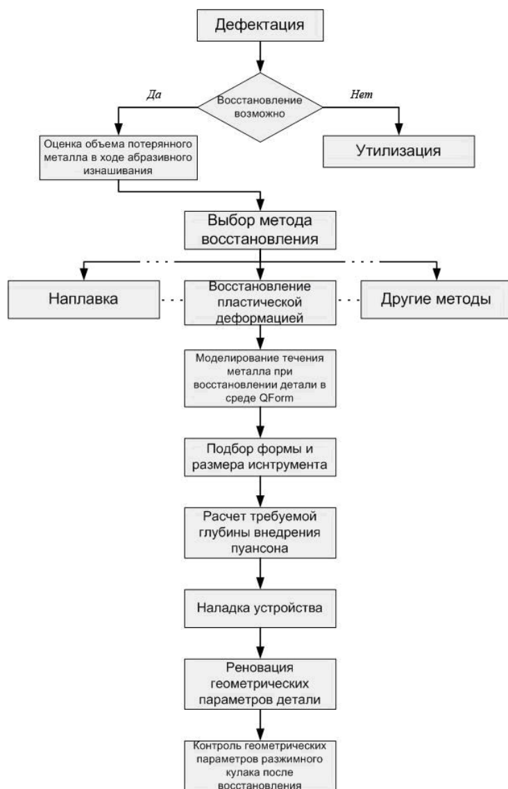
Рис. 3. Алгоритм восстановления разжимного кулака штампом
