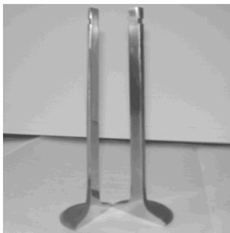
Рис.1. Продольные образцы клапанов, приготовленные для проведения исследований
