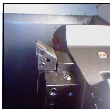
Рис.4. Интерфейс ввода технологических параметров (а) и резец на станке SL10 (б)
