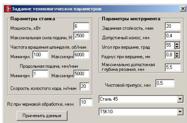
Рис.4. Интерфейс ввода технологических параметров (а) и резец на станке SL10 (б)
