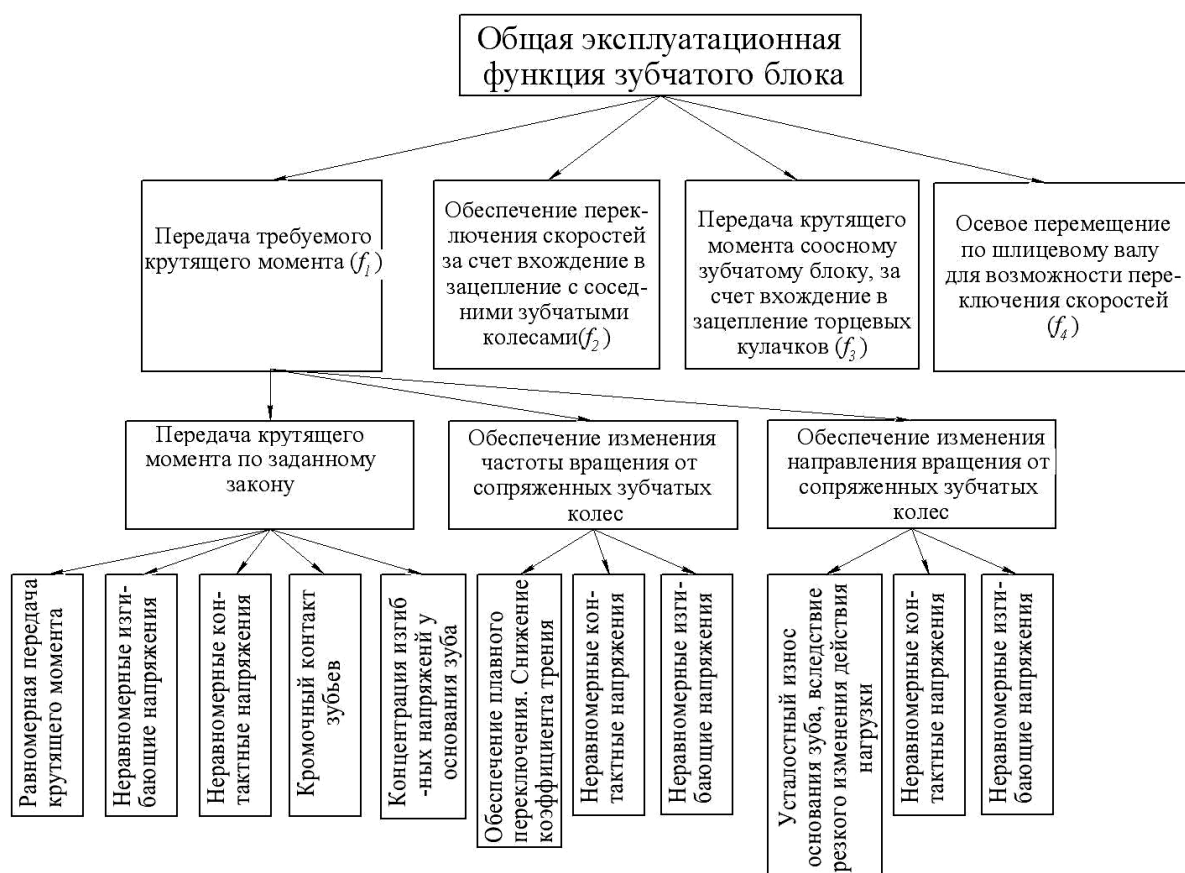
Рис. 2. Граф эксплуатационных функций зубчатого блока
