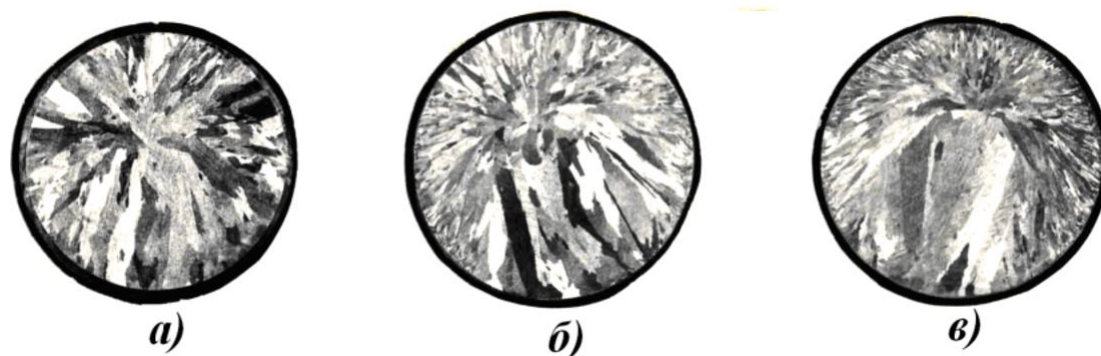
Рис. 3. Влияние температуры жидкого металла на макроструктуру заготовок ( d = 40 мм), поперечные темплеты, \times 1 : а – T_{ж.м.} = 1000 °С, б – T_{ж.м.} = 1100 °С, в – T_{ж.м.} = 1150 °С
