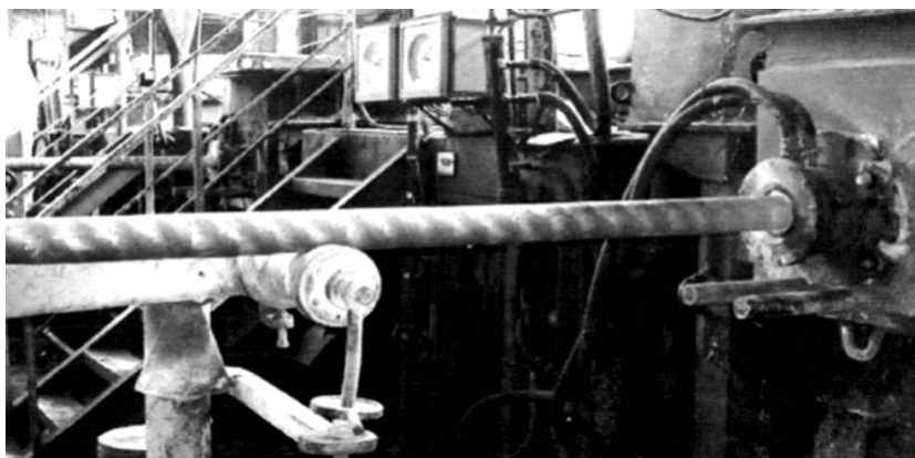
Рис.2. Установка горизонтального непрерывного литья -УГНЛ (не показаны узлы: вытягивания, порезки и складирования)
