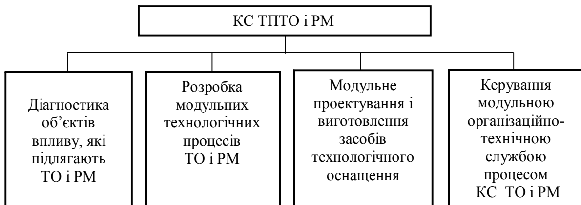
Рис.3. Схема комплексної системи технологічної підготовки виконання технологічних операцій технічного обслуговування й ремонту машин
