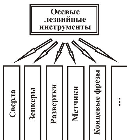
Рис. 1. Виды осевых лезвийных инструментов
