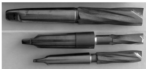
Рис. 16. Осевые лезвийные инструменты с многослойным композиционным нитрид титановым покрытием TiN – концевые фрезы (производства Румыния).
