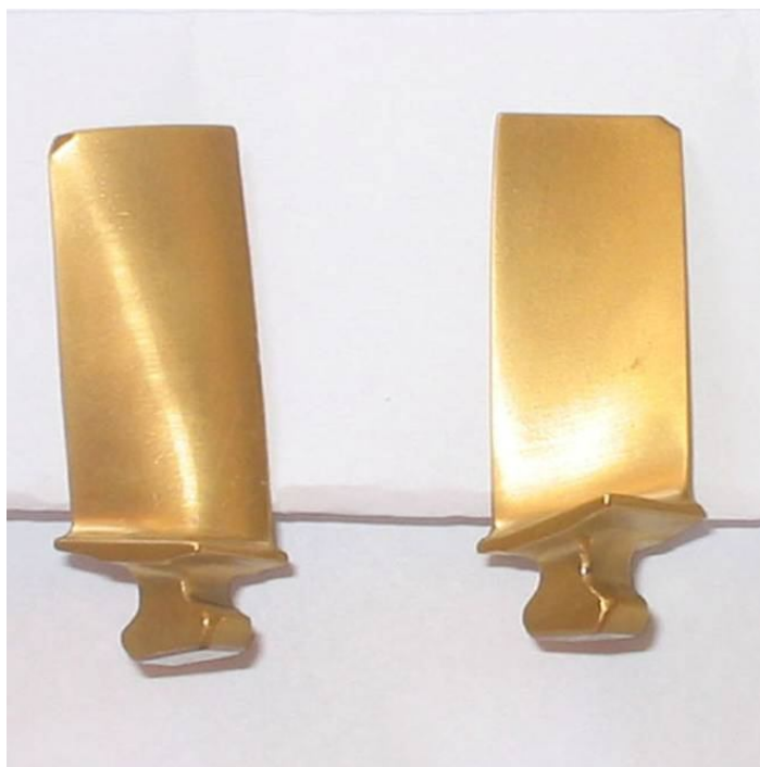
Рис. 2. Покрытие из TiZrN, нанесенное на лопатки компрессора вертолетного двигателя в вакууме плазменно-ионным методом
