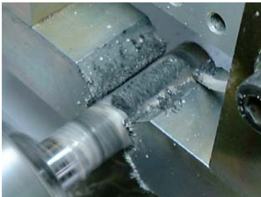
Рис 2. Магніто-абразивна обробка циліндричної заготовки
