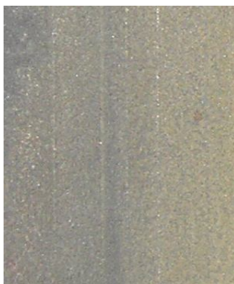
Рис. 2. Типова поверхня оброблена електроерозійним вирізанням.
