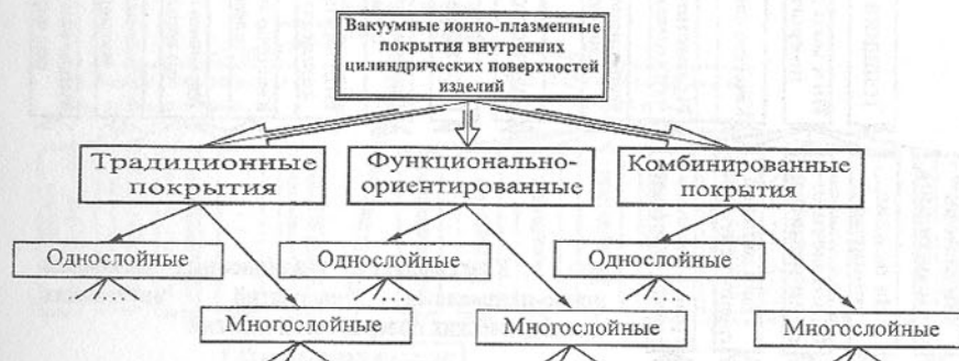
Рис. 2. Общая классификация вакуумных ионно-плазменных покрытий внутренних цилиндрических поверхностей изделий
