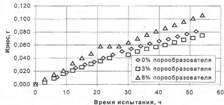
Рис. 4. Зависимость весового износа от времени испытания для образцов, изготовленных с применением разного количества порообразователя
