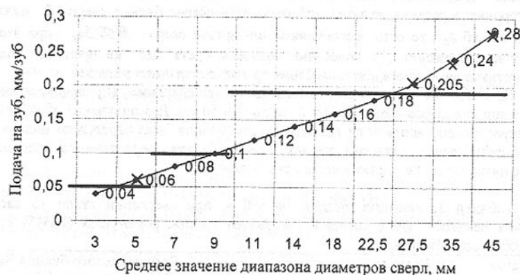
Рис. 2. Взаимосвязь значений допуска осевого биения сверла и подачи на зуб (обработка стали \sigma_B = 610 МПа; сверло точного исполнения, материал режущей части - быстрорежущая сталь)
