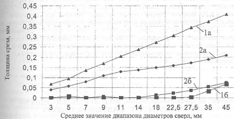
Рис. 5. Изменение толщины среза для различных диаметров сверл (обработка стали \sigma_B = 610 МПа, сверла точного исполнения, двухстороннее асимметричное резание): 1а и 1б – материал режущей части – Р6М5; 2а и 2б – материал режущей части – Т15К6 (максимальная и минимальная толщина среза соответственно).
