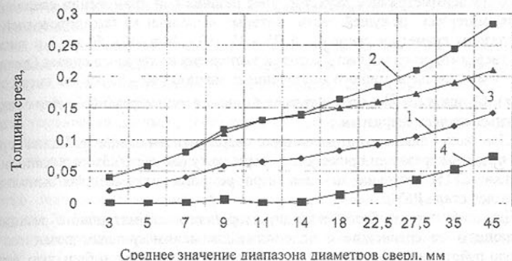
Рис. 4. Изменение толщины среза для различных диаметров сверл (обработка стали \sigma_B = 610 МПа; сверло точного исполнения, материал режущей части – твердый сплав Т15К6): 1 – симметричное резание; 2 – одностороннее асимметричное резание; 3 и 4 – двухстороннее асимметричное резание (максимальная и минимальная толщина среза соответственно).
