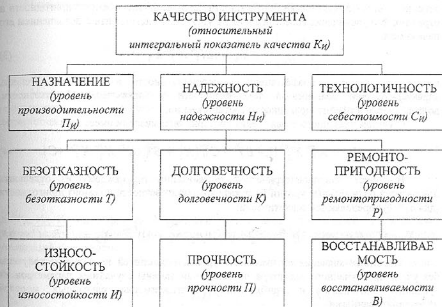
Рис. 1. Структурная схема основных свойств, составляющих качество режущего инструмента и определяющих эти свойства показателей.
