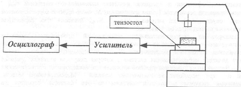
Рис. 1. Схема измерений при определении характеристик тензостол
