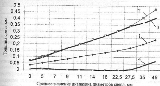
Рис. 3. Изменение толщины среза для различных диаметров сверл (обработка стали \sigma_B = 610 МПа; сверло точного исполнения, материал режущей части - быстрорежущая сталь Р6М5): 1 - симметричное резание; 2 - одностороннее асимметричное резание; 3 и 4 - двухстороннее асимметричное резание (максимальная и минимальная толщина среза соответственно).
