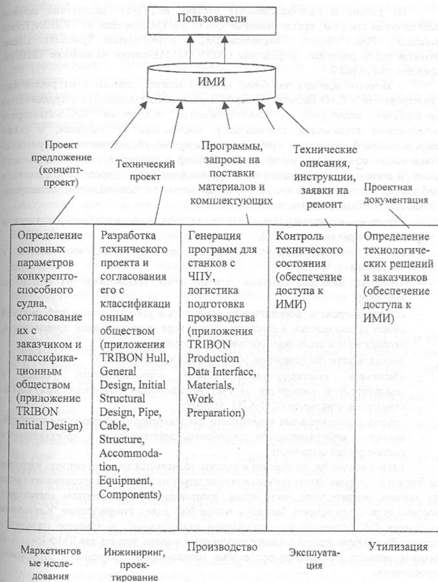
Рис. 2. Задачи, решаемые ИМИ на различных стадиях ЖЦ судна, на примере CAD/CAM/CAE-системы TRIBON
