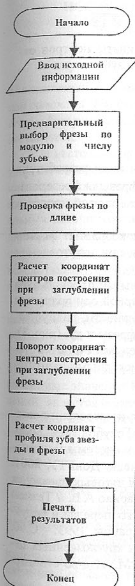
Рис. 2. Блок – схема программы по подбору параметра пальцевой модульной фрезы.
