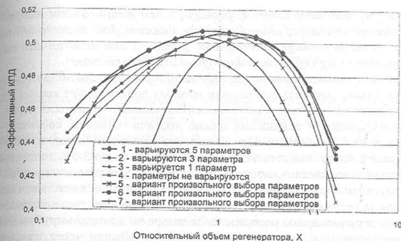
Рис.1. Пример оптимизации параметров двигателя Стирлинга по КПД
